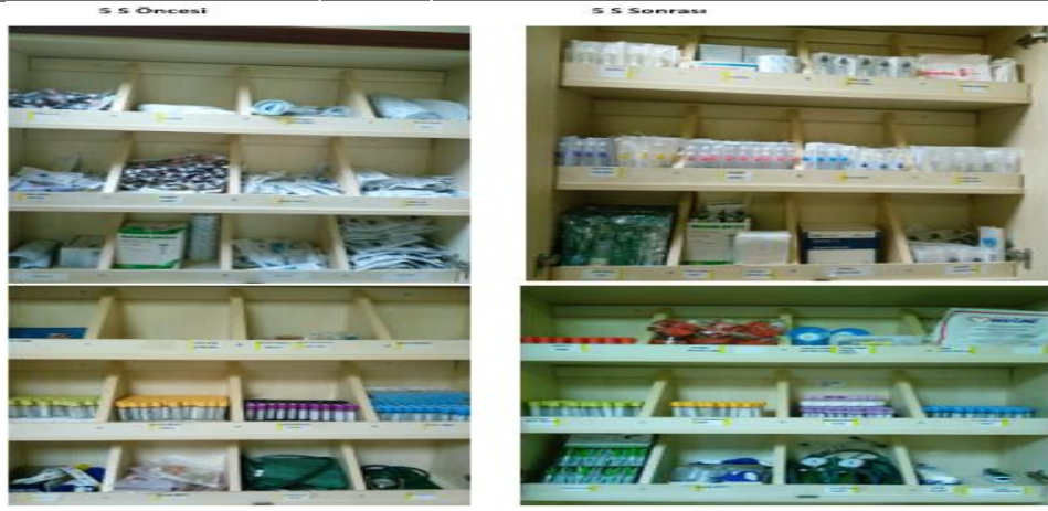
Şekil.9. 5S Öncesi ve 5S Sonrası Görünüm
