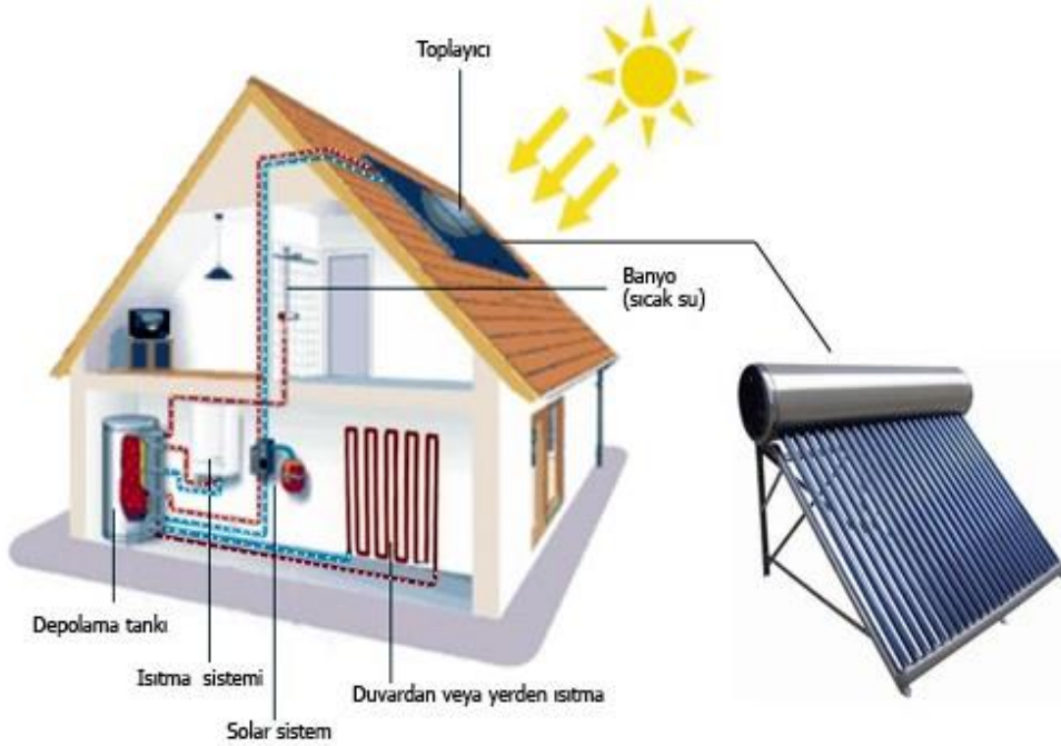
Şekil 1. Güneş Enerjili Isıtma Sistemi ve Yapıdaki Gösterimi (URL 12)
