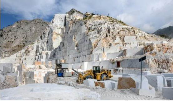
Şekil 1: Açık Ocak Madencilik (Tepe ve Üç Yönde İlerleyen) Örnekleri
