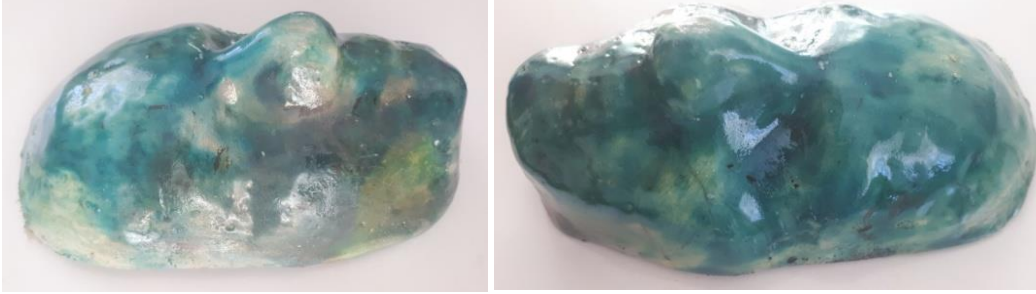
Resim 2 950°C'de Raku Fırınında 3 Saatlik Pişirim Sonrası Elde Edilen Akçini Çamuru Üzerine RC1 Raku Sır Uygulamalarına Ait Görüntüler
