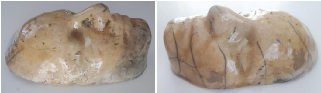
Resim 4 980°C'de Raku Fırınında 3 Saatlik Pişirim Sonrası Elde Edilen Akçini Çamuru Üzerine RC 2 Raku Sır Uygulamalarına Ait Görüntüler
