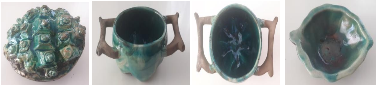
Resim 1. 980°C’de Raku Fırınında 3 Saatlik Pişirim Sonrası Elde Edilen Seramik Döküm Çamuru Üzerine RC 1 Raku Sır Uygulamalarına Ait Görüntüler
