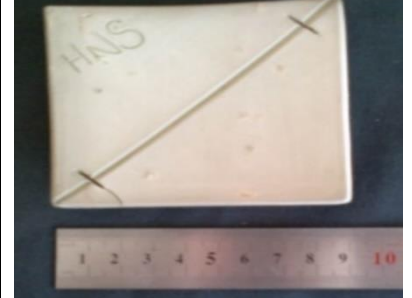
Resim 18. Formül 9'un 1280°C de altı saatlik Nabertherm fırında bisküvi pişirimi işleminden sonraki görüntüsü. H.N.S. Arşivi
