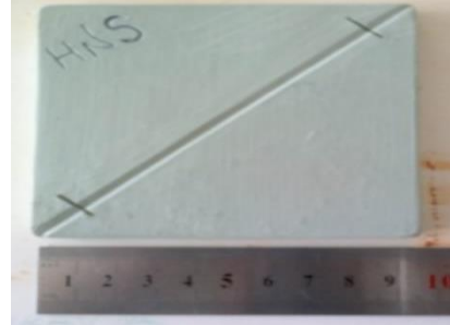
Resim 19. Formül 10'un dört saatlik öğütme işleminden sonraki kurumuş, fırınlamaya hazır haldeki tablet görüntüsü. H.N.S. Arşivi
