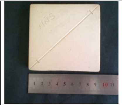
Resim 4. Formül 2'nin 1280°C de altı saatlik Nabertherm fırında bisküvi pişirimi işleminden sonraki görüntüsü. H.N.S. Arşivi
