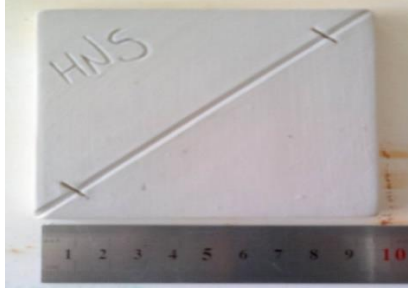
Resim 9. Formül 5'in dört saatlik öğütme işleminden sonraki kurumuş, fırınlamaya hazır haldeki tablet görüntüsü. H.N.S. Arşivi
