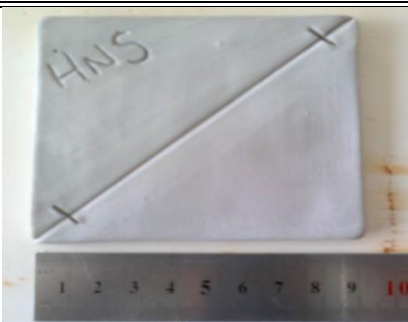
Resim 11. Formül 6'nın dört saatlik öğütme işleminden sonraki kurumuş, fırınlamaya hazır haldeki tablet görüntüsü. H.N.S. Arşivi
