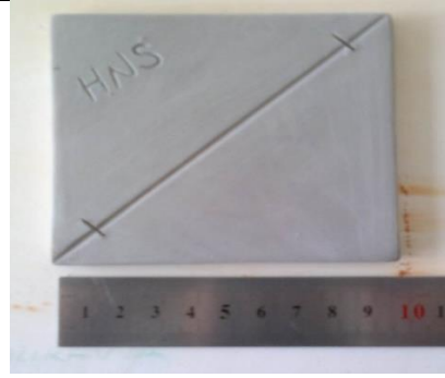
Resim 5. Formül 3'ün dört saatlik öğütme işleminden sonraki kurumuş, fırınlamaya hazır haldeki tablet görüntüsü. H.N.S. Arşivi
