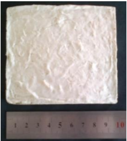
Resim 31. Formül 1 ile 10 gr.'lık şerit halinde kesilmiş gazete karışımının, 1280°C de 6 saatlik Nabertherm fırında bisküvi pişirimi sonrası görüntüsü. H.N.S. Arşivi
