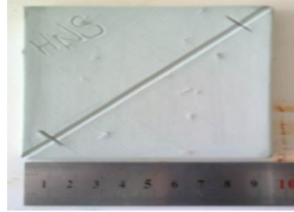
Resim 17. Formül 9'un dört saatlik öğütme işleminden sonraki kurumuş, fırınlamaya hazır haldeki tablet görüntüsü. H.N.S. Arşivi
