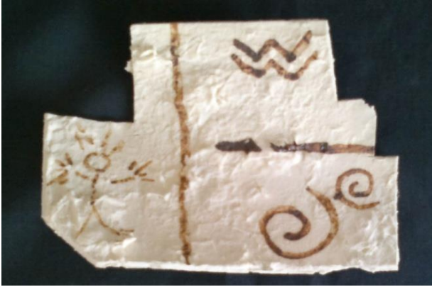
Resim 43. Plaka denemesi, 1280°C de altı saatlik Nabertherm fırında bisküvi pişirimi işleminden sonraki görüntüsü. H.N.S. Arşivi
