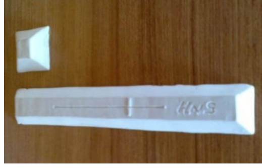
Resim 2. Formül 1'in 1240°C de altı saatlik Nabertherm fırında bisküvi pişirimi işleminden sonraki görüntüsü, görüldüğü üzere beyaz bir renk oluşumu ile sonuçlanmıştır. H.N.S. Arşivi
