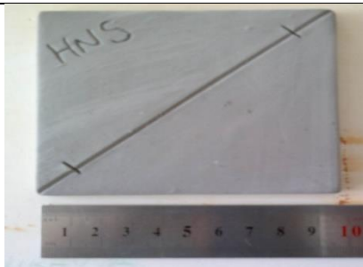
Resim 7. Formül 4'ün dört saatlik öğütme işleminden sonraki kurumuş, fırınlamaya hazır haldeki tablet görüntüsü. H.N.S. Arşivi
