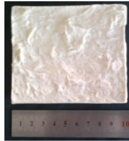
Resim 32. Formül 1 ile 10 gr.'lık üçgen kesilmiş oluklu mukavva karışımının, 1280°C de 6 saatlik Nabertherm fırında bisküvi pişirimi sonrası görüntüsü. H.N.S. Arşivi
