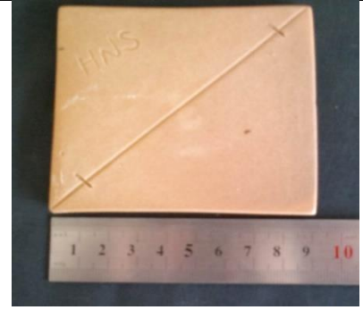
Resim 6. Formül 3'ün 1280°C de altı saatlik Nabertherm fırında bisküvi pişirimi işleminden sonraki görüntüsü. H.N.S. Arşivi
