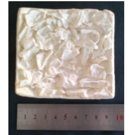
Resim 33. Formül 1 ile 10 gr.'lık farklı ebatlarda kesilmiş yumurta kartonu karışımının, 1280°C de 6 saatlik Nabertherm fırında bisküvi pişirimi sonrası görüntüsü. H.N.S. Arşivi
