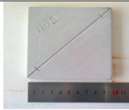
Resim 3. Formül 2'nin dört saatlik öğütme işleminden sonraki kurumuş, fırınlamaya hazır haldeki tablet görüntüsü. H.N.S. Arşivi
