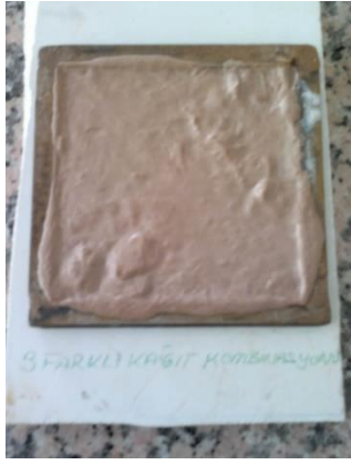
Resim 34. Formül 1 ile üç farklı kağıt kombinasyonunun karışımından sonraki, 10×10 cm.'lik uygulamanın görüntüsü.
